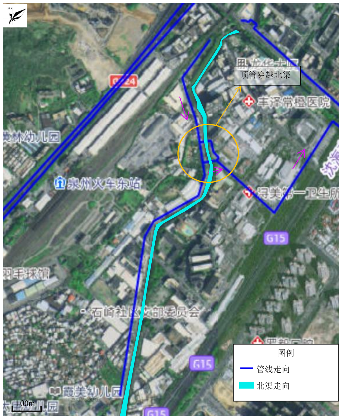
图 2.4-1 北高干渠污水管道布置图
